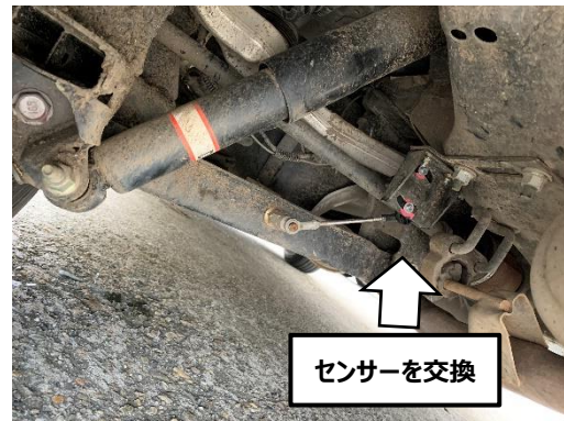
4-9 修理後の様子
