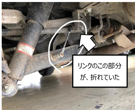
4-8 破損したセンサー
