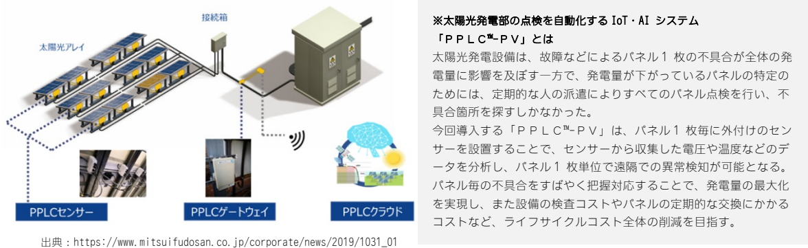
図 2-12 太陽光発電設備の保守管理 IoTプラットフォーム全体図
