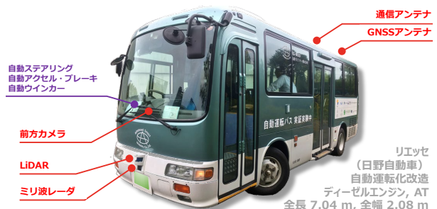
図 2-4 自動運転車両の運転システム概要
