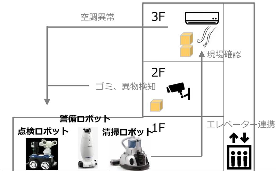
ビル全体でのロボット統合管制イメージ
