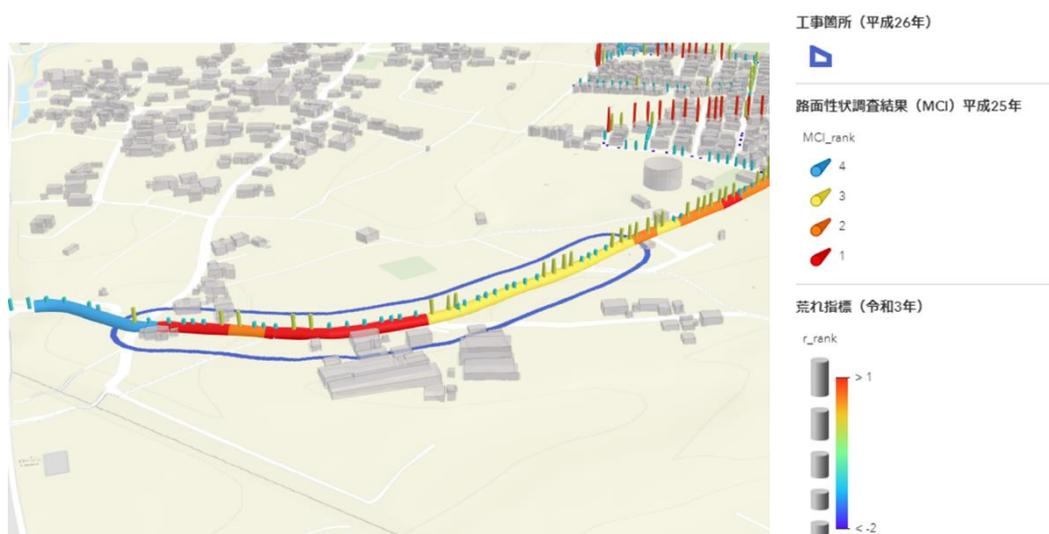
図 74 補修あり (工事箇所) の荒れ指標の可視化
