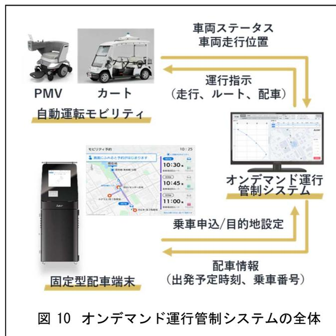
運行管制画面の例を図 11 に示す。今回使用した管制システムは、ダイヤ運行を基本としつつ、乗車予約状況に応じてダイヤ（運行時刻、運行ルート）をリアルタイムに最適変更することができるアルゴリズムを搭載したことで、乗車待ち時間の短縮・走行距離短縮に伴う運行電力削減によるコスト削減、CO2 削減に寄与できるものとなっている。
