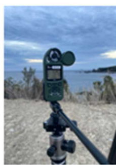
風速計設置の様子
