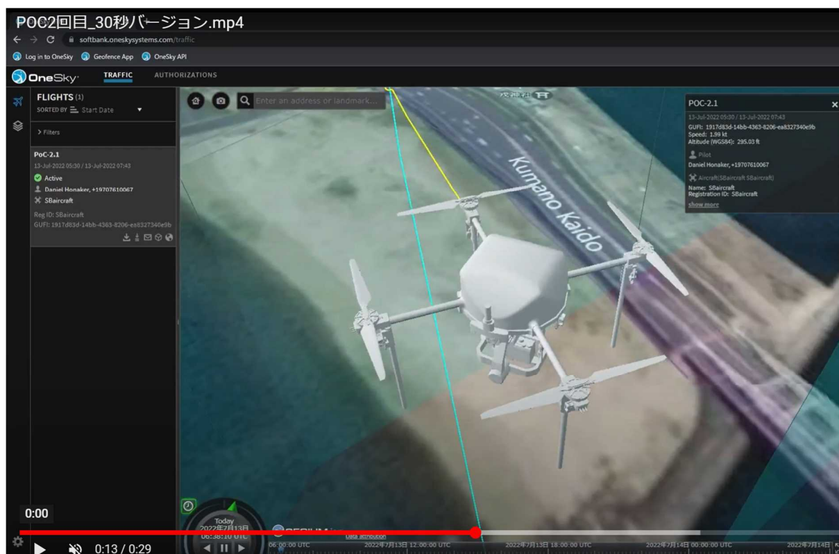
図表 46 ドローン航行中の監視画面（3枚目橋梁点検時）
