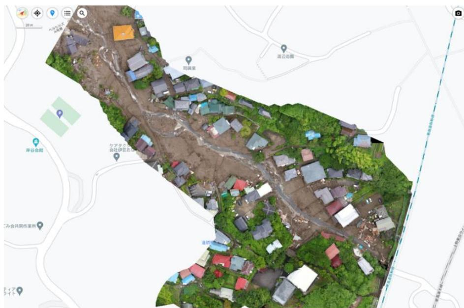
さらに、オルソ画像を地理情報システム（GIS）上に表示することで、単に「画像」としてではなく、地理空間情報として、その機能を拡張することができる。次図は、令和3年に熱海市で発生した土砂災害現場のオルソ画像を、住宅地図上にレイヤーとして表示したもので、土石流により被災した住宅の位置・戸数も、画面上で容易に把握することができる。また、オルソ画像と地理情報システムの併用により、被災状況の全体的な把握だけでなく、防災担当者間での情報共有を目的とした「共通状況図」としての活用も可能となり、救助・復旧作業の効率化も期待できる。
