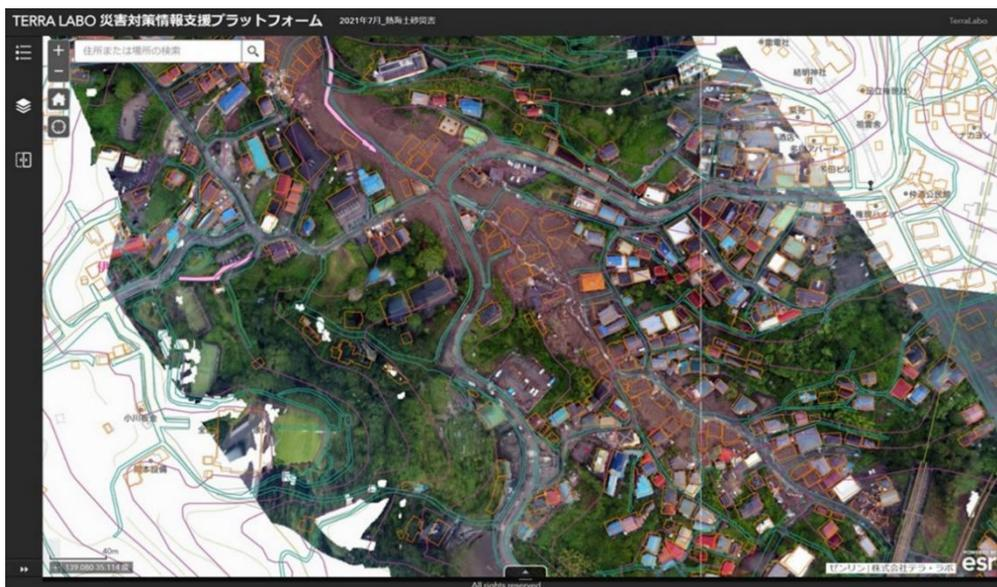
本実証実験では、ラップ率の設定が適切であれば、1回の飛行により約8.5haの空撮・オルソ画像化も可能であること、高低差がある地形での効率的な空撮を可能にする設定などが検証された。今回検証された空撮・自動航行の諸設定を規格化し、マニュアル化することにより、市民・企業が、その保有するドローンを用い、オルソ画像を作成することは十分可能と考える。なお、今回の実験では、実験現場でのオルソ画像作成用に、高処理グラフィックボードを搭載したノートPCを使用した。今後の仙北市での社会実装化においては、たとえば、市民・企業等がマニュアルに基づいて空撮部分のみを担当し、空撮により得られた画像データは、クラウドサービスによりオルソ画像化され、また、防災情報プラットフォームにも反映されるというようなシステムを構築することにより、実運用での工程を簡略化することが可能で、さらに、システムとマニュアルが共有されるならば、他の市町村への横展開にもつながるものとする。また、ドローンの利活用の範囲が拡張されることから、防災分野以外での応用も期待される。
