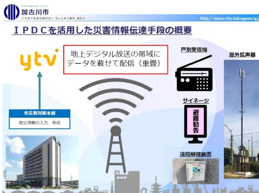
IPDC を活用した災害情報伝達手段の概要 (契約締結式における加古川市説明資料)
