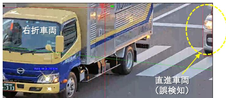
図4-1-13 車両用AIカメラ・台数カウント 検証結果の原因
