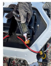
バッテリー残量計測装置
