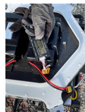
バッテリー残量計測装置
