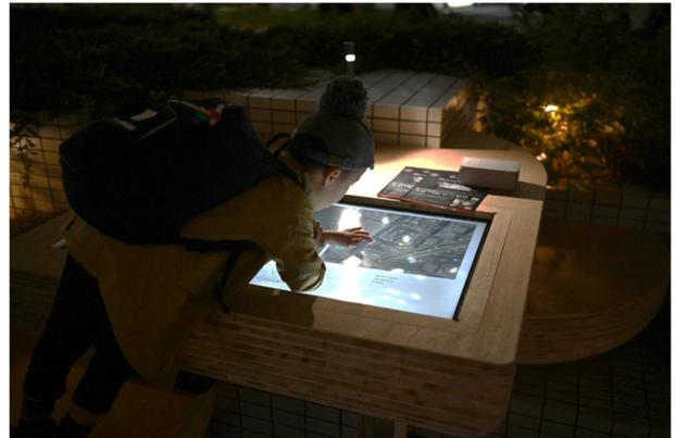
有楽町電気ビルのモビリティ・スポット（写真右左）においては情報発信機能をもつサイネージを水平に設置し、モビリティのリアルタイムな位置情報をはじめとする実証実験に関する情報発信を行いました。屋外広告物条例の規制にかからないよう、水平にサイネージを設置し覗き込まないと画面が見えないような工夫を施し、屋外での設置のハードルを乗り越えました。
