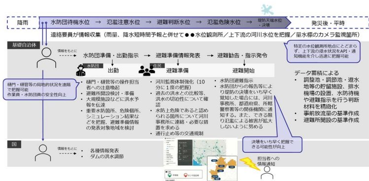
図 基本的な発災時対応フローと、対応する浸水センサー及びデータ連携基盤活用（アンケート結果集約）
