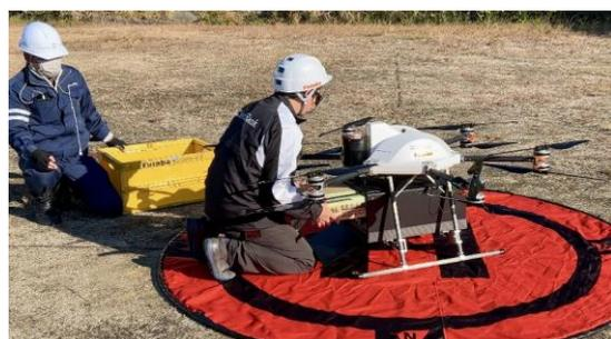
○遠隔操縦/バックアップ通信/3次元地図を活用したドローンによる
