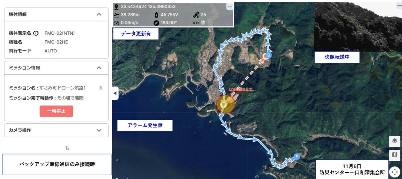
図表 65 バックアップ無線通信のみ接続時のドローン遠隔操作システム画面
