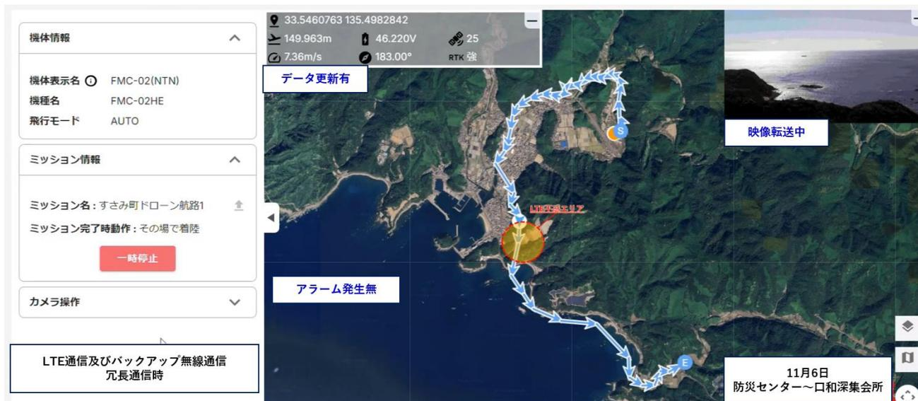
図表 63 LTE 通信及びバックアップ無線通信での冗長通信時のドローン遠隔操作システム画面
