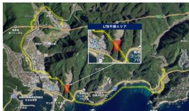
複数回の物資輸送を想定しJR線路横断を避けるためトンネル上空を飛行するルートとした。その結果、LTE不感エリアを通るルート設計となり、LTE不感エリアでは衛星通信を利用したバックアップ通信にて遠隔操縦・監視を実施。
