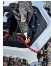
バッテリー残量計測装置
