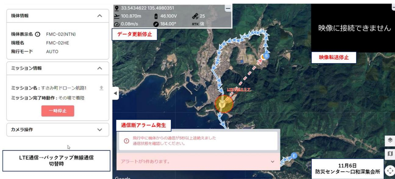
図表 64 LTE 通信→バックアップ無線通信へ切替時のドローン遠隔操作システム画面
