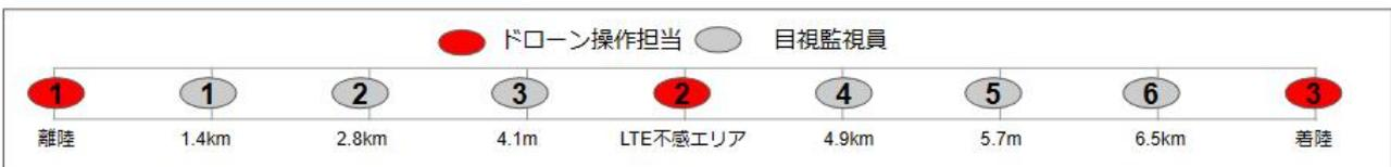
図表 30 ドローン航路区間における見張り員の配置図 (大規模避難所)
