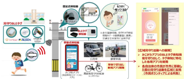
図 加古川市における BLE タグ検知の全体像
