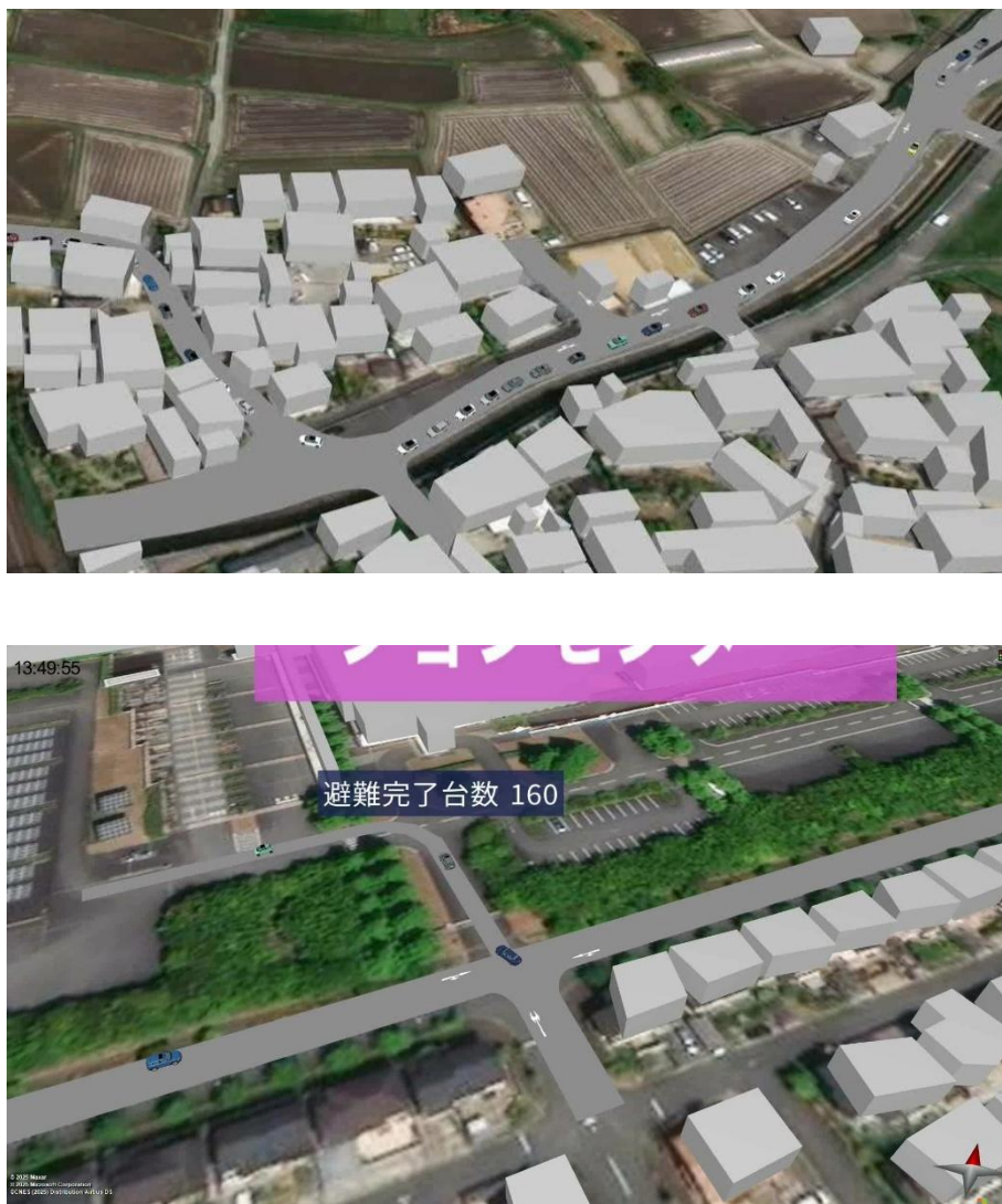
図表 18 ミクロ交通シミュレーションの結果（スクリーンショット）
