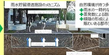
雨水を保水・浸透させると共に、植栽の成長を助け、晴天時は蒸発散効果で、ヒートアイランド対策にも奇功
