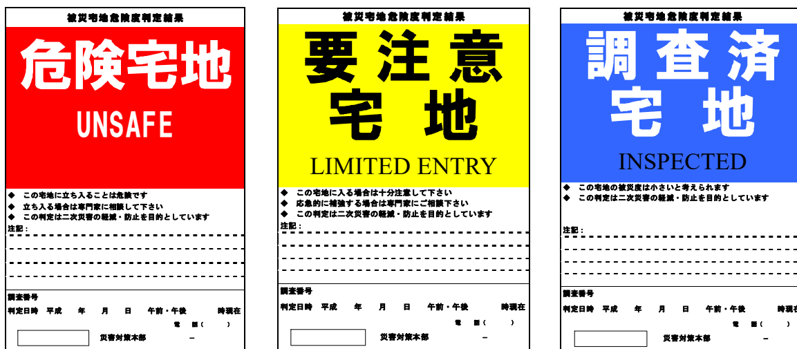
図 2.1 被災宅地危険度判定ステッカー
