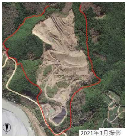
図参 3.2.1 採石場跡地で発生した土砂流出の様子
