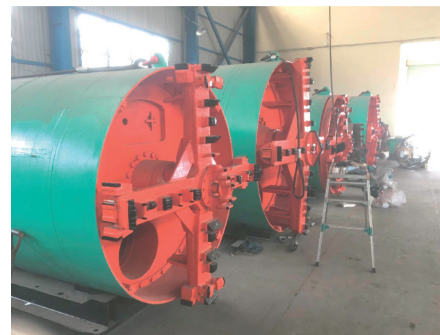
VN ホーチミンで使用している泥濃式掘進機
