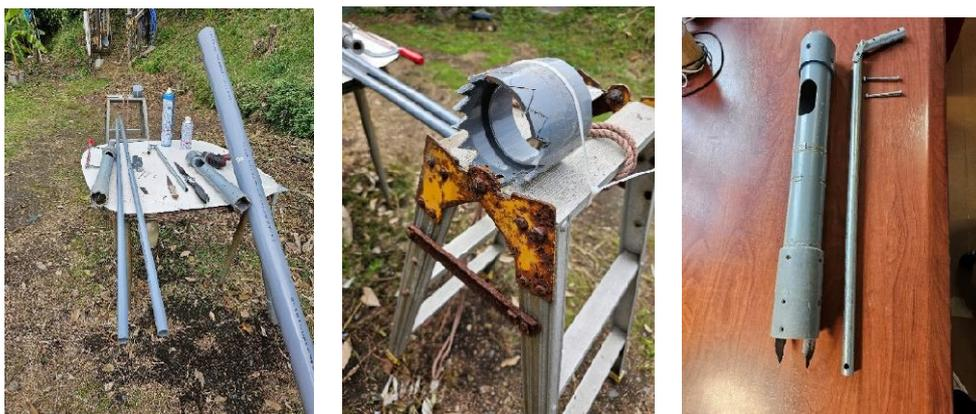
手掘り井戸用、外枠パイプと土砂を吸出す掘り器の井戸掘り道具の部品
