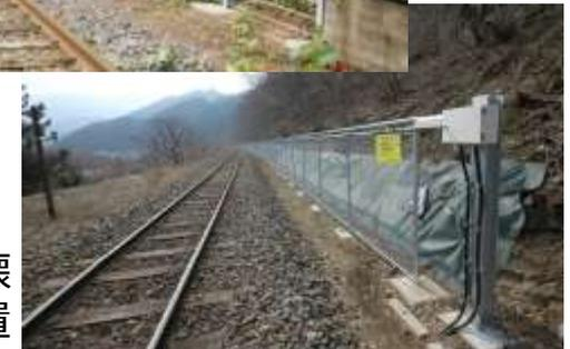
土砂崩壊検知装置
