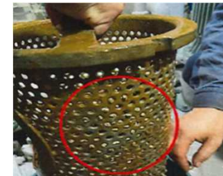
航海後のストレーナーの様子 (エレメントの目に詰まる軽石)
