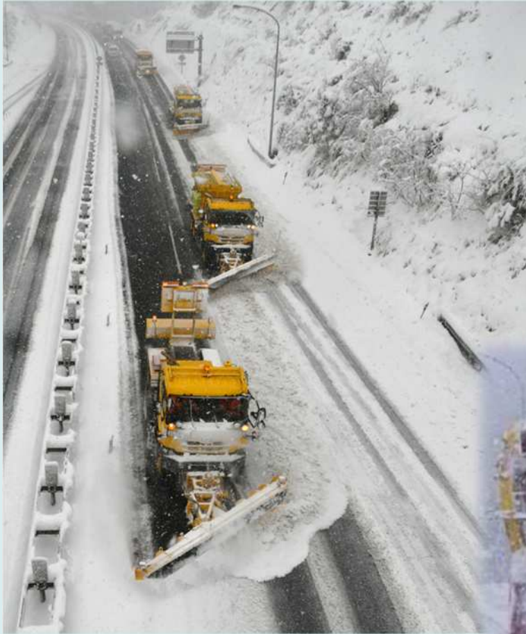
大型除雪車による梯団除雪
