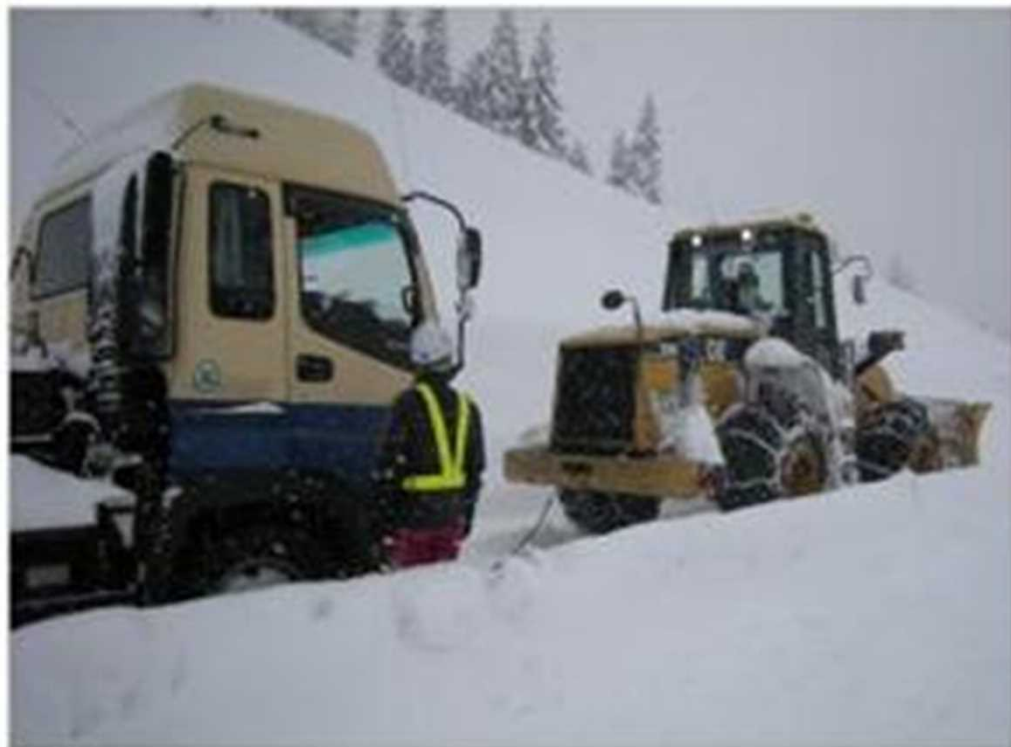
・スタック車両の引き出し状況
