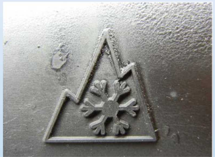
スノーフレイクマーク タイヤの側面に表示 されています。
