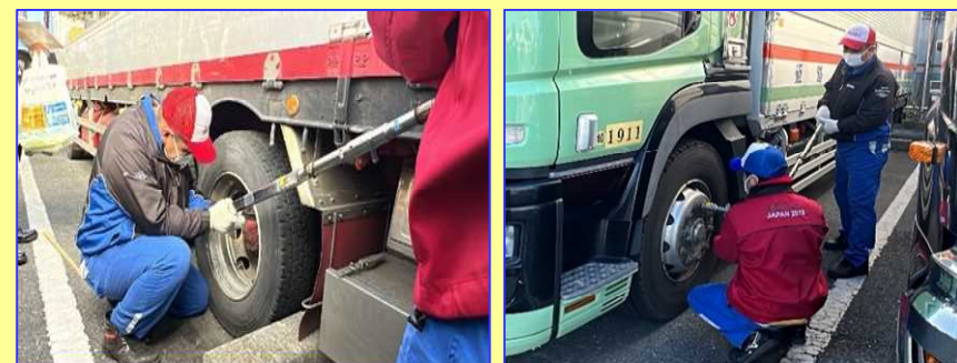
トルク・レンチによりナットの緩みを確認
