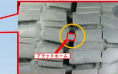
残り溝深さが「プラットフォーム」に達している状態。冬用タイヤとして使用できません。
