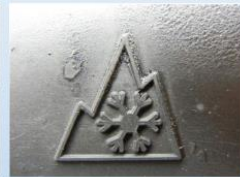
スノーフレックマーク タイヤの側面に表示されています。
