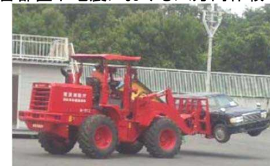
車両移動のための具体的方策 (例:ホイールローダーによる移動)
