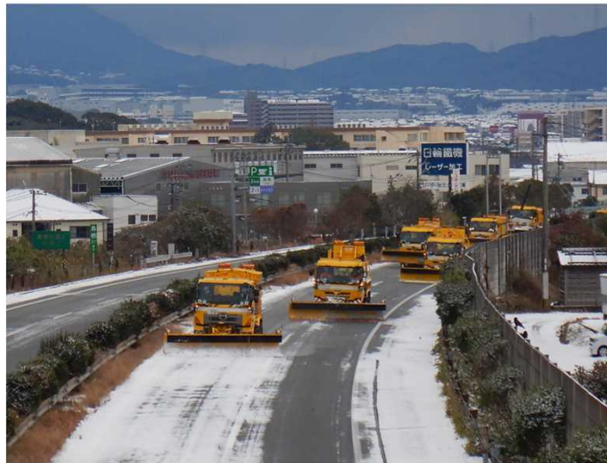
除雪作業車による梯団除雪
