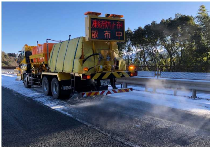
温塩水散布車による融雪作業
