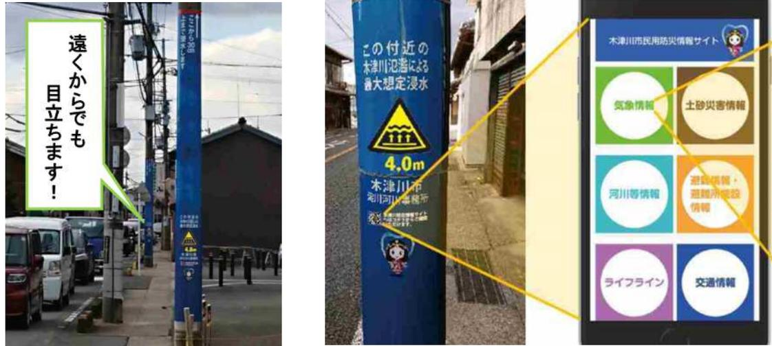
全面を覆うことで遠くからも一目で浸水リスクがわかるようにし、合わせて2次元バーコードを設置することで、防災情報サイトにアクセスできるようにした
