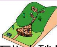
山腹や川底の石や土砂が豪雨などによって一気に下流へと押し流される土石流や山の斜面や自然の急傾斜の崖、人工的な造成による斜面が突然崩れ落ちる崖崩れにより起こる災害。
