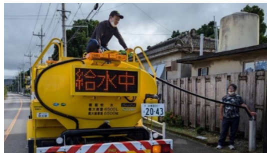
給水機能付き散水車での応急給水(大宜味村)
