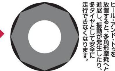
ヒール・アンド・トウを放置すると、多角形摩耗へと進展し、振動が発生したり、冬タイヤとして安全に行きなくなります。
