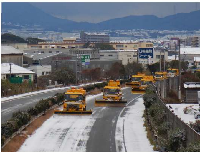
除雪作業車による梯団除雪
