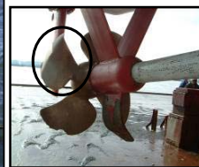
破損(変形)したスクリュー
