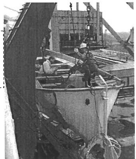
PSCの現場(救命艇の確認)
