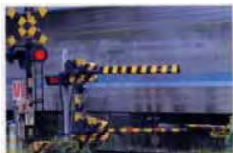
大型遮断装置 + 二段型遮断装置
