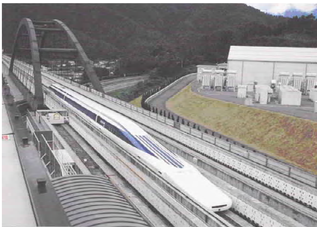
走行試験中の超電導リニア車両
