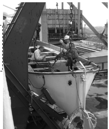
PSCの現場(救命艇の確認)
