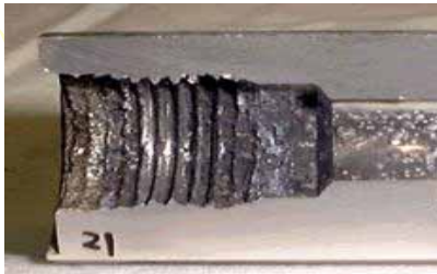
【腐食によりネジ山がなくなった】
