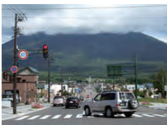
写真3 | 敷地境界線から建物の壁面までの素材が歩道と同じ素材になっている。建物の色彩は白色系又は淡色系で統一された。通りの先にそびえる羊蹄山への眺望を妨げない、高い電柱と茶色い信号機を設置した。
