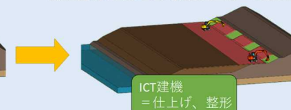
従来の建機 = 護岸工周辺の掘削や荒掘削
