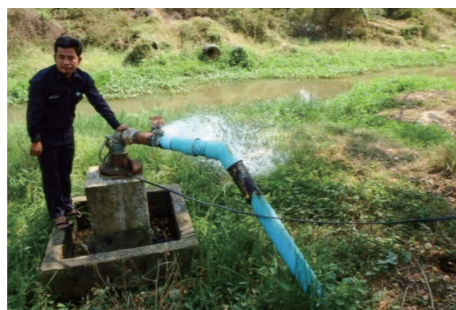
水源(井戸)からの取水量調査
