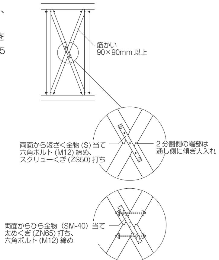
図 3 - 45 たすき掛け筋かいの交差部の補強例
