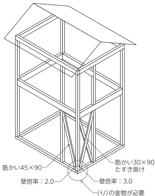
耐力壁が直交する柱の引抜きは、壁倍率の大きい方を採用します。
