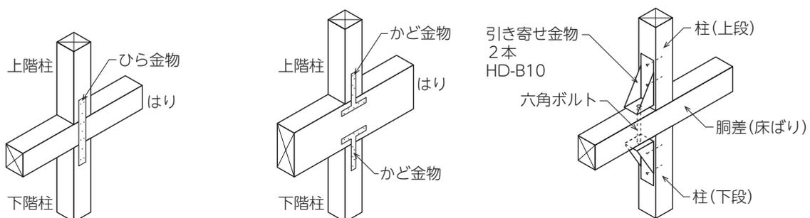
図 3-32 金物による管柱の補強の例
