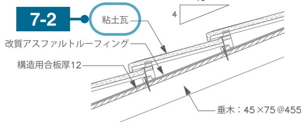
法第 22 条区域内にある建築物の屋根を通常の火災による火の粉による建築物の火災の発生防止の為に政令で定める技術的基準の以下 2 つのいずれかに適合
