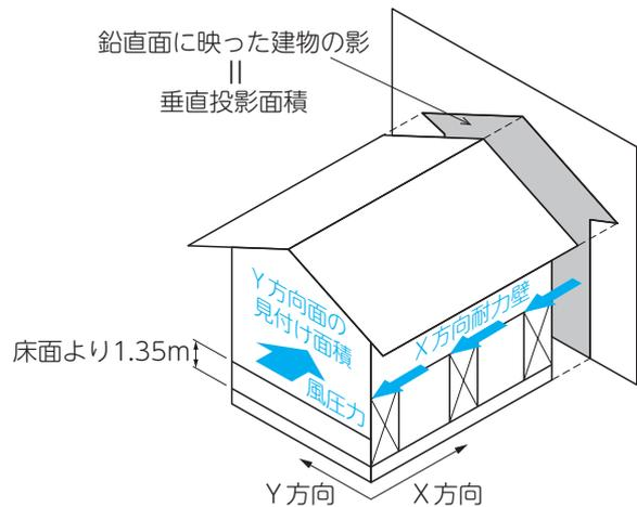
図 3-7 風圧力と耐力壁
