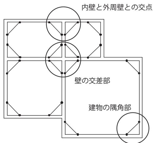
図 3-47 火打材の設置箇所の例
