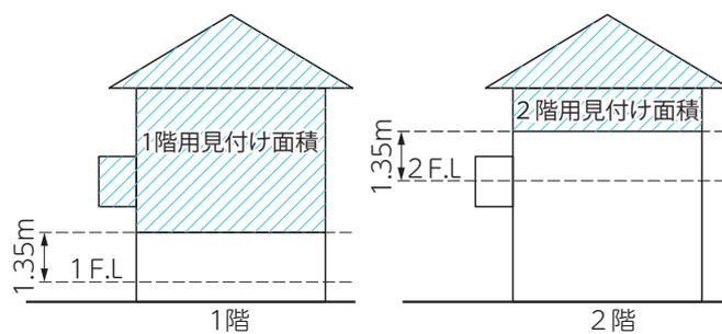
図 3 - 6 見付け面積の算出
