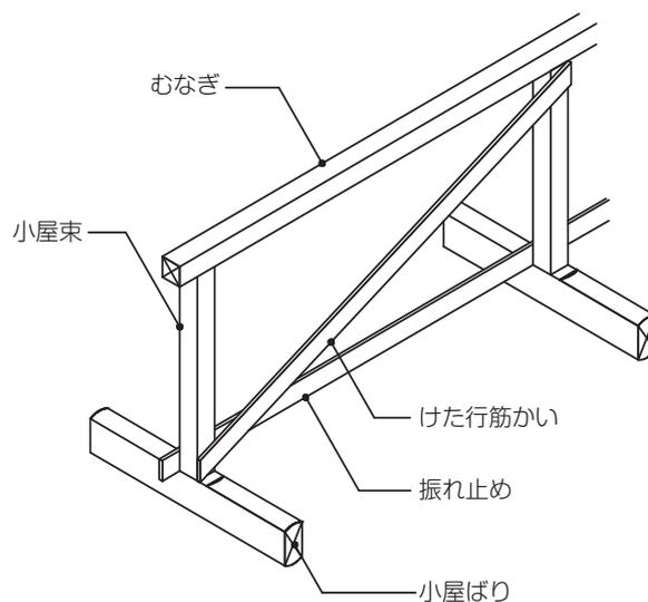
図 3 - 48 小屋組の構造方法の例
