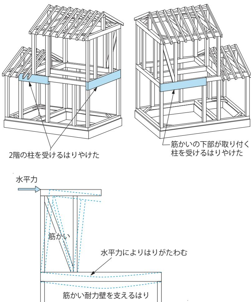
図 3-43 横架材の断面寸法の配慮
