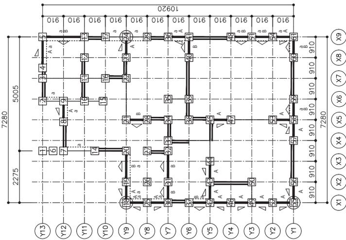
凡例 一 筋壁 二 筋かいダブル 筋かいシングル ① 通し柱
