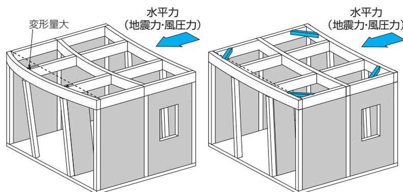
図 3-46 水平構面への火打材等の設置
