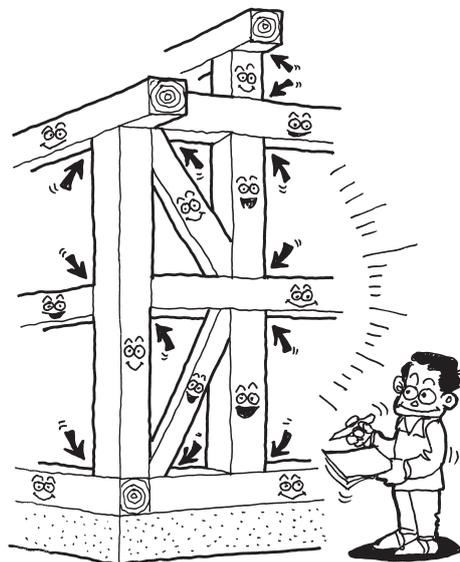
耐力壁・準耐力壁等が取り付いている柱の柱頭・柱脚は、発生する応力に耐えられる接合方法とします。
