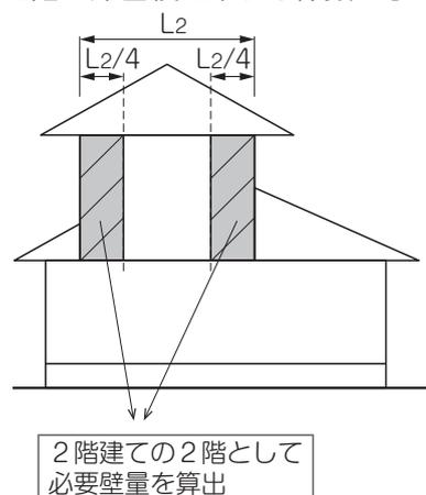
図 3-18 床面積に乗ずる係数の求め方
