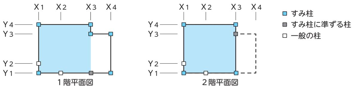
図 3-31 すみ柱・すみ柱に準ずる柱
