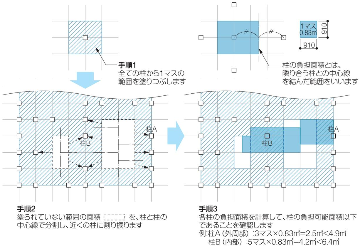
図 3 - 28 柱の負担面積のチェック方法の例
