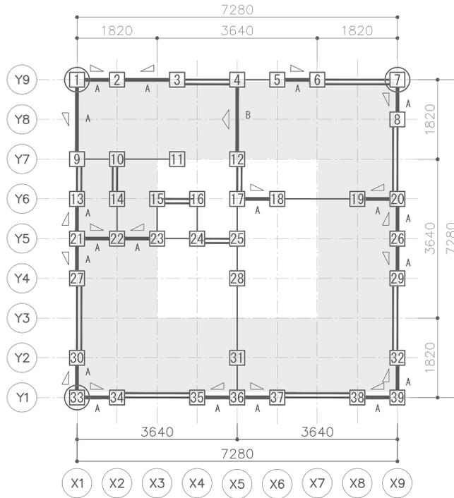
9-8 凡例 — 一般壁    — 耐力壁    △ 筋かいダブル    □ 柱
