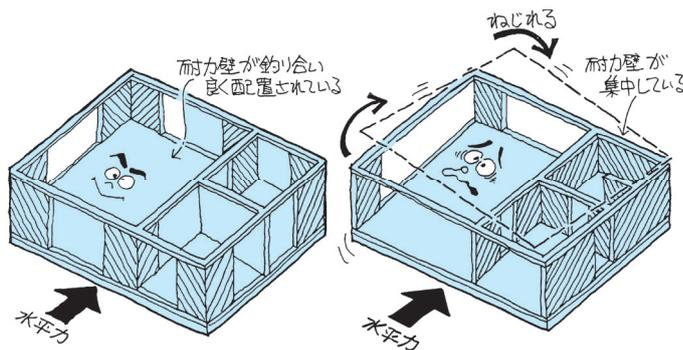
耐力壁の配置が偏っていると、地震力や風圧力が加わったときに、建築物がねじれて耐震性が損なわれます。壁配置のバランスを確認する方法として、平12建告第1352号に「四分分割法」が定められています。
