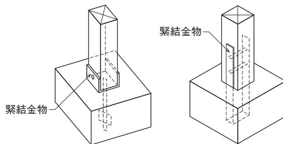
図 3 - 40 柱を基礎に緊結した例
