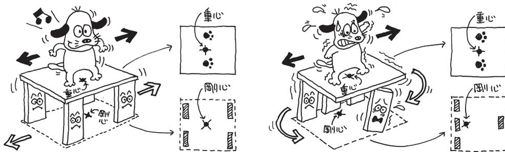
四分分割法によって、耐力壁の配置のバランスを確認します。
