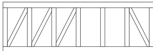
図 3 - 44 バランスの良い構面と悪い構面の例
