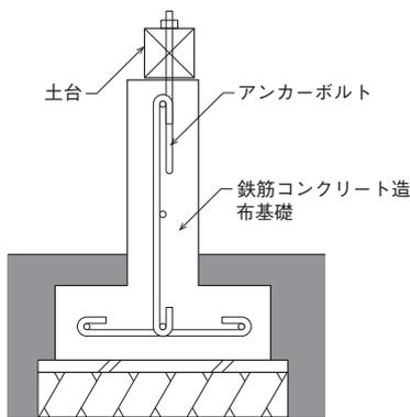
図 3 - 39 土台を基礎に緊結した例
