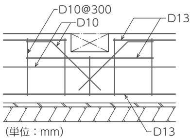
注) 換気口まわりは、D13の横筋とD10斜め筋により補強する。D13横筋の長さは、500mm + 換気口の幅の長さ + 500mmとする。D10斜め筋の長さは、 $2 \times 400\text{mm} = 800\text{mm}$ 以上とする。(コンクリートの呼び強度  $24\text{N/mm}^2$  の場合)。
