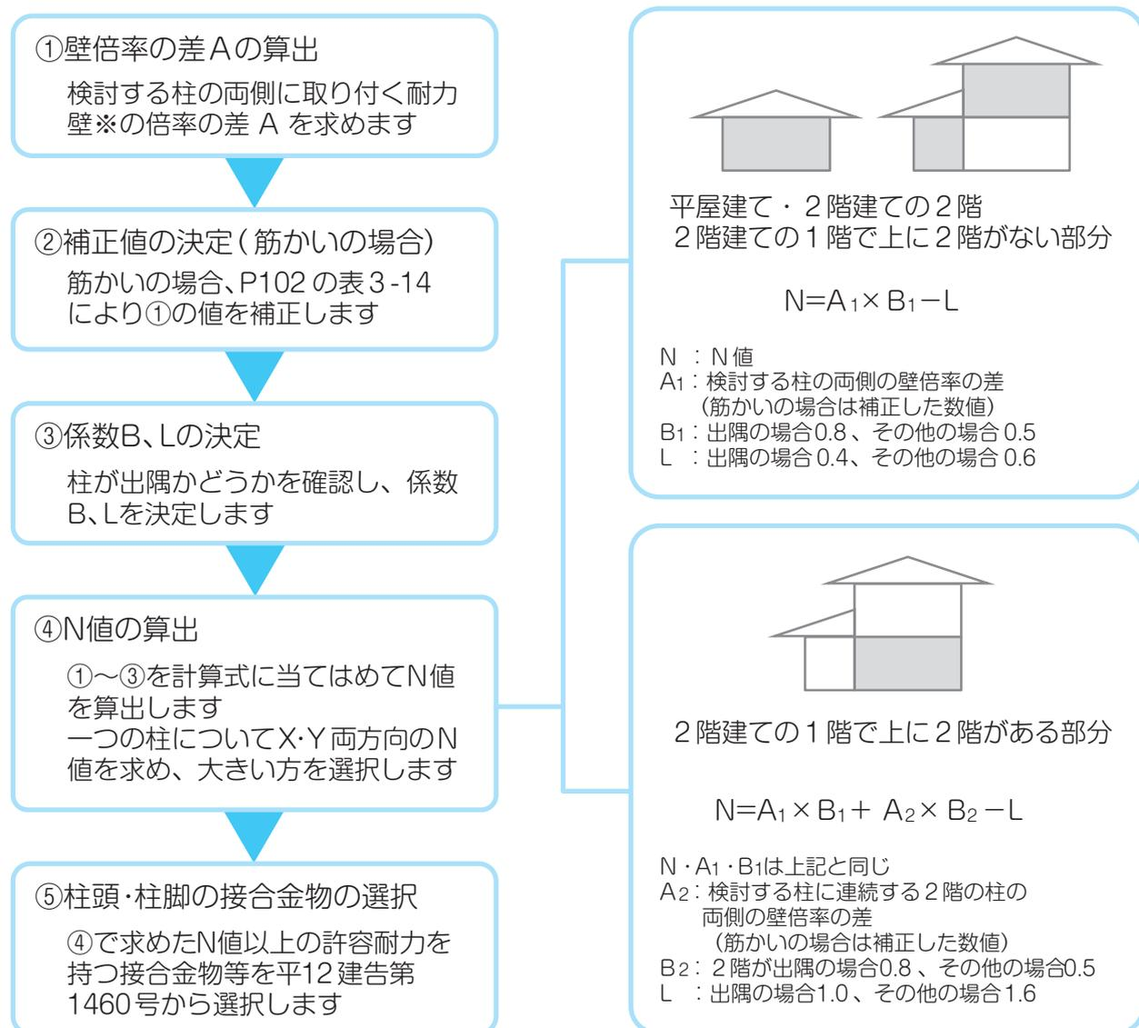
図 3-19 N 値計算法の流れと計算式
