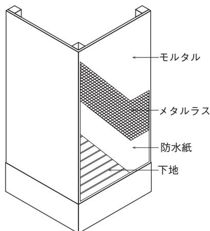
図 3-50 モルタル外壁の防水紙の規定
