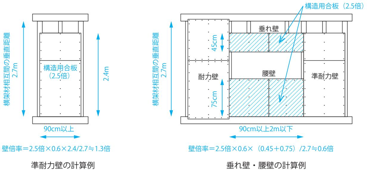
図 3-9 準耐力壁等の倍率の計算例
