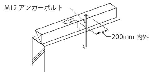
図 3 - 41 土台用アンカーボルトの設置例
