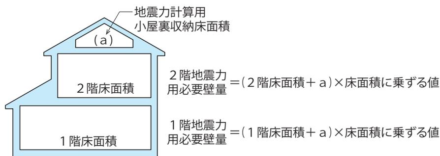
図 3-4 小屋裏収納がある場合の床面積の補正
