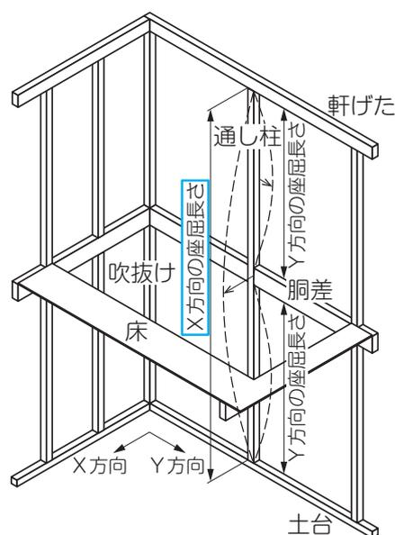
図 3 - 30 吹抜けに面した通し柱
