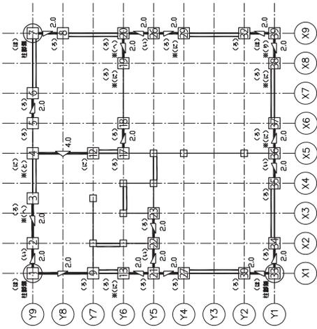
■ 1階柱頭柱脚金物算定平面図
