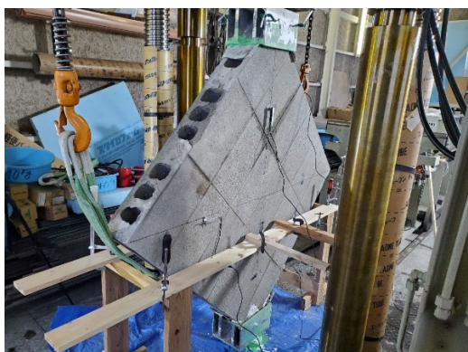
フィリピン製ブロックで構成される構造部材の力学性状実験
