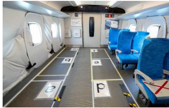
実証実験(8月3日)におけるN700S試験車両のレイアウト(車椅子スペース6席)
